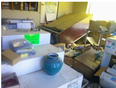
写7 商店の物品散乱の室内 浸水により浮いた大型冷蔵庫は水がひいた時に転倒
