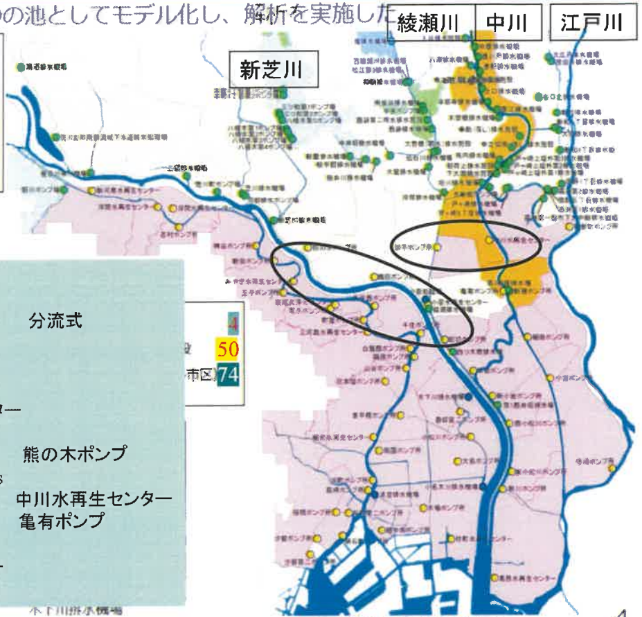
図 荒川下流部の集水区の設定
